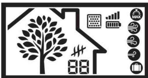
A árvore simboliza a respiração da casa. A árvore ganha e perde folhas a uma velocidade proporcional à taxa de renovação de ar na casa, ou seja, o caudal de ventilação da VMI®. Permite compreender a reação da VMI®. Se a respiração acelera significa que a qualidade do ar se degradou e que a VMI® está a solucionar o problema.
