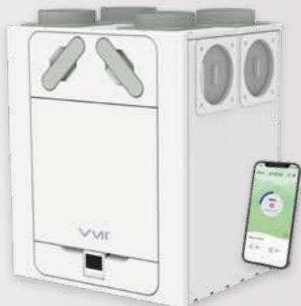
La VMC doble flujo Eyota 600 garantiza una calidad de aire óptima en **viviendas de hasta 450 m<sup>2</sup>**. **Filtra el aire** entrante y elimina la **humedad, CO<sub>2</sub> y COV**, mientras proporciona **confort térmico y ahorro de energía**. Su intercambiador de calor de alta eficiencia **recupera hasta el 93% de las calorías del aire extraído** para calentar el aire insuflado.
