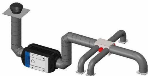
L'installation d'une Purevent sur un réseau centralisé implique l'installation d'une bouche pour les surfaces inférieures à 110m<sup>2</sup>, et deux bouches pour les surfaces supérieures. Pour cette configuration il faudra alors des bouches de ø160mm. L'emplacement des bouches est recommandé dans les zones neutres (couloir ou cage d'escalier) et dans la partie la plus centrale du local pour optimiser la répartition de la ventilation. Par exemple :
